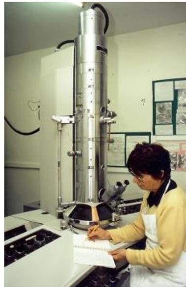
***Ci-dessus, Claude Coulomb (CNRS) au pupitre d'un microscope électronique Hitachi (Université d'Avignon). À gauche, micrographie d'un protoplaste<sup>2</sup>, renfermant des chloroplastes, obtenue par celle-ci.***
